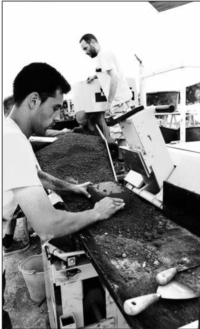
Pour faire des briques en terre crue, les ouvriers compactent un mélange de terre et de ciment à l'aide d'une presse. CÉDRIC VINCENSIN
